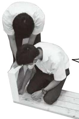
脚は安定性を重視して鉄製にし、座面は、夏に熱くなりすぎず、冬に冷たくなりすぎないように木材で制作しました。商工高校の校章をレーザー加工で刻印しています。
