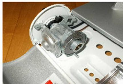
カセットコンロの圧力感知安全装置
