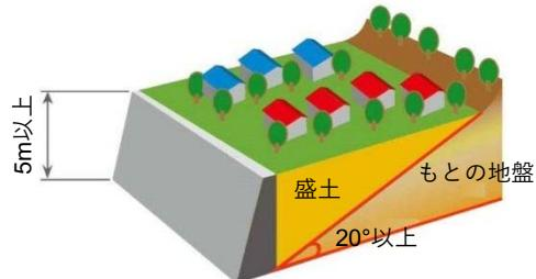
国土交通省「大規模盛土造成地の滑動崩落対策推進ガイドライン及び同解説」より
